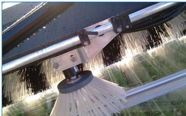
Имеет специальную щетку, спроектированную под 4 м. венло, быстро и легко заменяемую распылительную насадку. Скорость может быть установлена до 35 метров в минуту.
