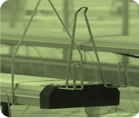
На каждый лоток будет установлена 1 проволока для поворота роста растений. Поворотные проволоки будут прикреплены к передним крышкам 12 мм винтами.
