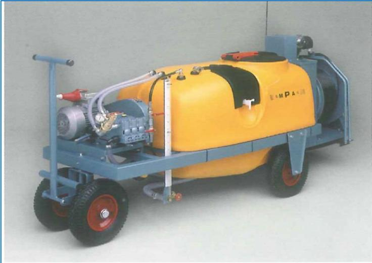
3 ед. бака объемом 1000 л, внутри которого готовится раствор для обработки, соединенный с машиной для обработки. Данный резервуар работает под давлением 50 бар 400 вольт. К нему прилагается шланг диаметром 1/2, устойчивый к давлению в 85 бар.
