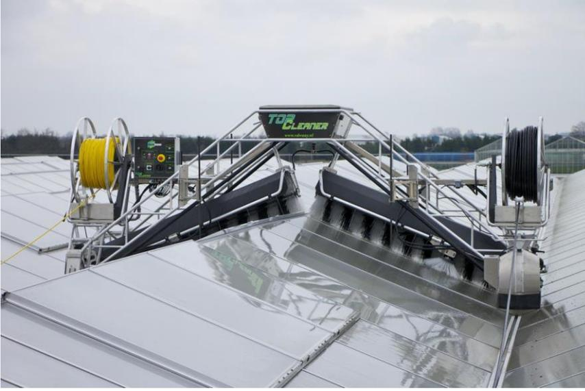
Для того, чтобы обеспечить наилучшую продуктивность растений в теплице, необходимо, чтобы растения равномерно получали свет. Для этого необходимо чтобы стекла были максимально чистыми. С помощью машины для смывания порошка для затенения и
