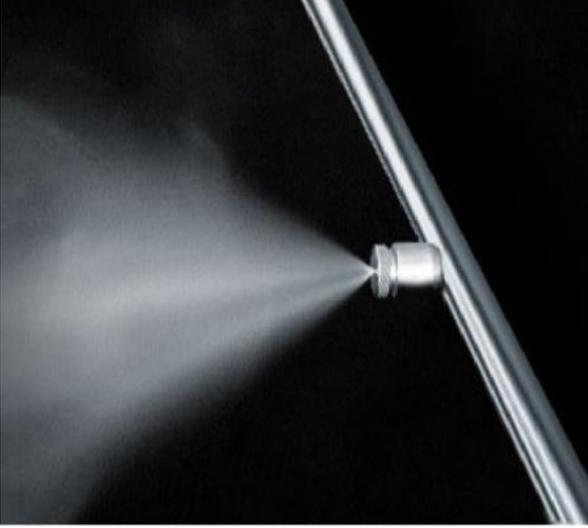
Технология затуманивания основывается на разбрызгивании воды из специальных сопел под высоким давлением. Капельки воды испаряются в воздухе в виде тумана, при этом воздух охлаждается и повышается относительная влажность. Давление воды в системе затуманивания составляет 1.000 psi (70 бар). Благодаря тому, что капли воды маленькие, процесс испарения ускоряется. Это значение давления является стандартным значением, принятым во всем мире. В системе
