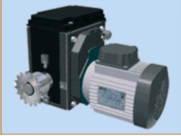
Будет использован мотор марки Ridder, с защитным и ограничительным выключателем. Моторы будут поставлены вместе с гальванизированной монтажной пластиной. Для вал соединения будет соединительная цепь, которая будет защищать мотор и вал от трений и изгибов.
