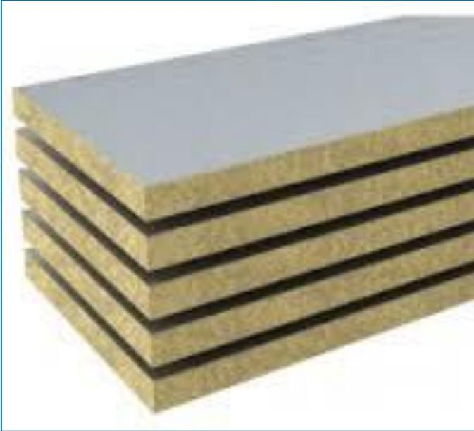
Стеновые панели толщиной 12 см облицованы с двух сторон металлическим листом толщиной 0,35-0,40 мм. Наполнитель – минеральная вата. Монтаж панелей будет обеспечиваться внецентровым замком, который даёт возможность соединения панелей между собой. Для замаскировки отверстий замков во время монтажа, будут использованы панельные заглушки из ПВХ. Аксессуары для основы, которые будут использованы в монтаже панелей-
